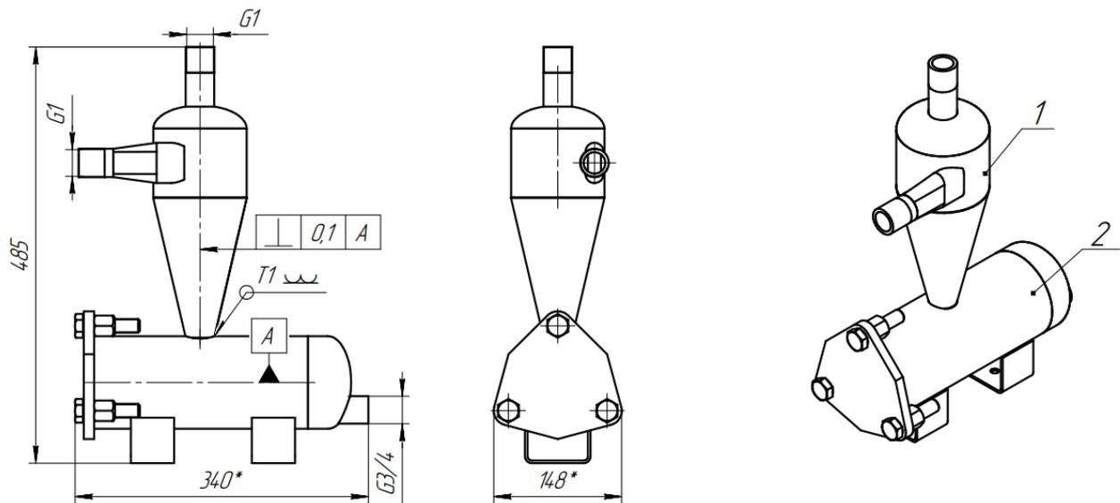
**Рис. 3** Габаритные и присоединительные размеры гидроциклона ПВО-ГЦ-1025-А
