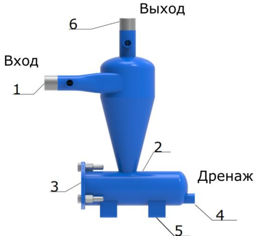
Рис. 2 Основные части гидроциклона ПВО-ГЦ-1040
