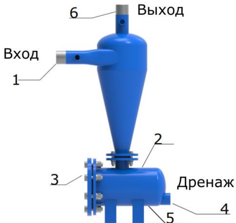
Рис. 2 Основные части гидроциклона ПВО-ГЦ-1050
